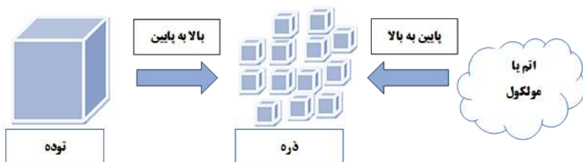
شکل ۲. دو روش تولید نانو ذرات: از بالا به پایین - از پایین به بالا
